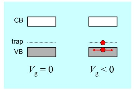
$$p(V_{\rm g}) + N_{\rm T}^{+}(V_{\rm g}) = -C_{\rm ox}V_{\rm g}/q$$
