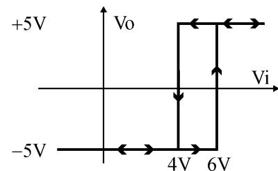
2: Considere o astável implementado com dois inversores *Schmitt-trigger*:
