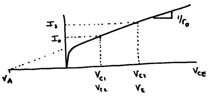
$$I_S = I_0 + (V_S - V_{CE}) / r_o$$
