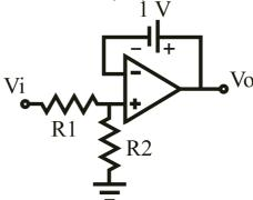
**b)** Determine a relação entre  $V_i$  e  $V_o$  do circuito mostrado abaixo composto por um amp-op ideal, um díodo ideal (passa tudo para tensões positivas e nada para tensões negativas) e duas resistências usadas em realimentação positiva.
