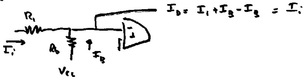
$$I_0 = I_i + I_3 - I_b = I_i$$
